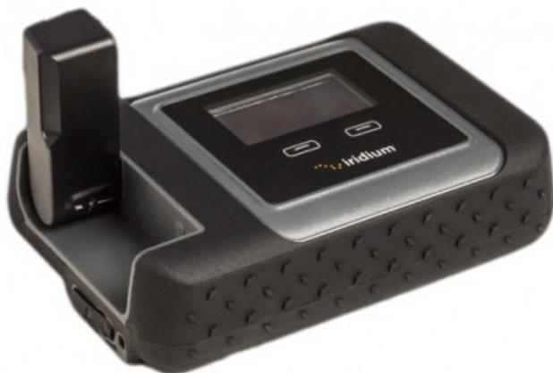
Iridium GO! - это первая в мире персональная точка доступа (WiFi хот-спот), допускающая одновременное подключение до пяти устройств, оснащенных WiFi, к системе спутниковой связи Иридиум (Iridium). Iridium GO! разработан совместно компаниями Iridium LLC, BEAM Communications и Maxwell на основе чипа/модема 9523.
